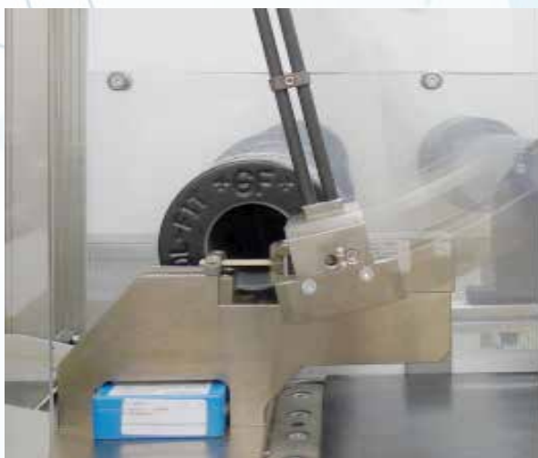
شکل ۲: دستگاه ضربه کششی در حال ضربه زدن
