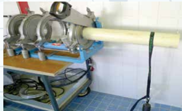
شکل ۱۳: آزمون اره که روی لوله PVC-U انجام شد
